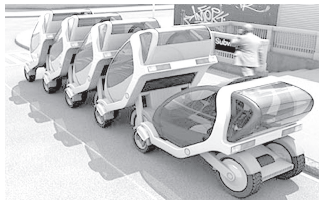
Корейский автопроизводитель Hyundai получил патент на конструкцию нового складного автомобиля. В сложенном виде изобретение занимает минимум места на парковке, но превращается в полноценное транспортное средство, если его разложить.
